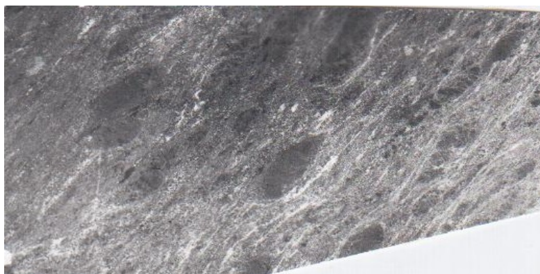
5.1.1 сурет – Ұсақтүйірлі, құмайттастағы линзалы-қабатты руда, ірі түйірлермен кристалданған қара-сұр түсті конкрециялар.
